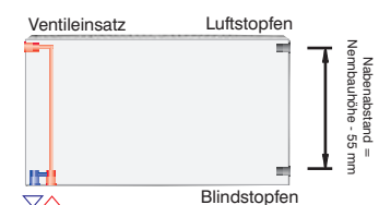
Anschlussvariante "Kompakt", Vorlauf / Rücklauf gleichseitig
