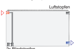
Anschlussvariante "Kompakt", Vorlauf / Rücklauf wechselseitig
