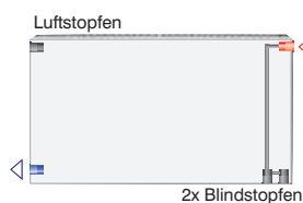
Anschlussvariante "Kompakt", Vorlauf / Rücklauf wechselseitig
