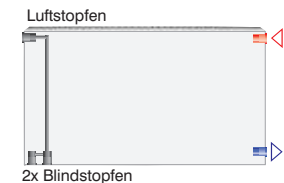
Anschlussvariante "Kompakt", Vorlauf / Rücklauf wechselseitig
