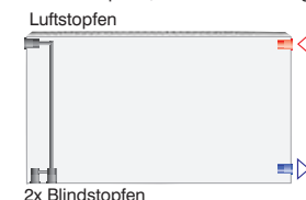
Anschlussvariante "Kompakt", Vorlauf / Rücklauf wechselseitig
