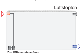
Anschlussvariante "Kompakt", Vorlauf / Rücklauf wechselseitig
